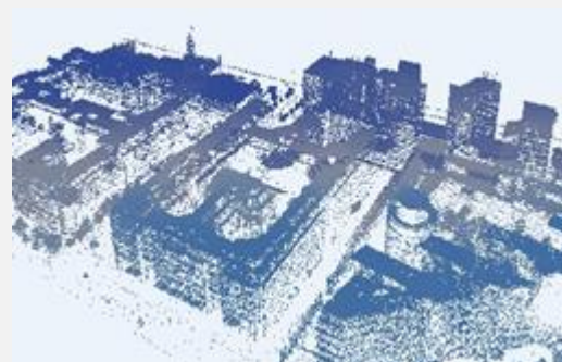
Digitales Oberflächenmodell (Punktwolke generiert aus Stereo-Luftbilder)
